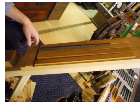
溝に箸を置き、固定してカンナをかけます。
