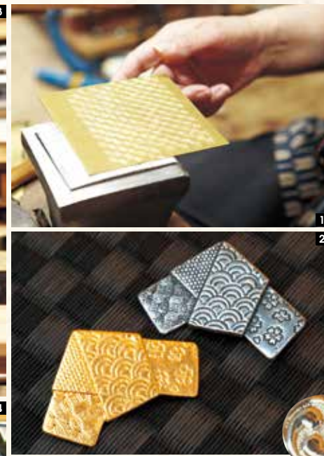
1 作品の元になる金板 2 かざり金具の技を駆使して作られたブローチ。細かい模様は塩澤さんならではの 3 糸鋸を使って真鍮板(しんちゅういた)に飾りをつける 4 塩澤さんが所有する無数の鑿。これが美しい飾りを生み出す
